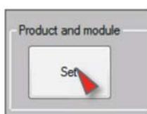
Quando il campo prevede l'inserimento alfanumerico è necessario inserire da tastiera il valore desiderato e, per il settaggio del parametro, è fondamentale premere il tasto accanto al campo d'inserimento.
